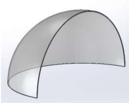
Figure 25 : évidage avec la fonction coque
